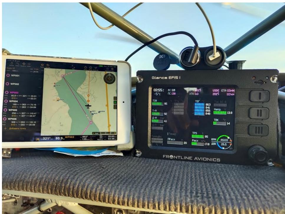
Рисунок 13.2-3. Бортовые компьютеры, вид из кабины гидросамолета
